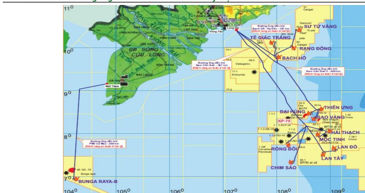
Hình 10: Sơ đồ các đường ống dẫn khí nối vào các nhà máy điện khí của POW
